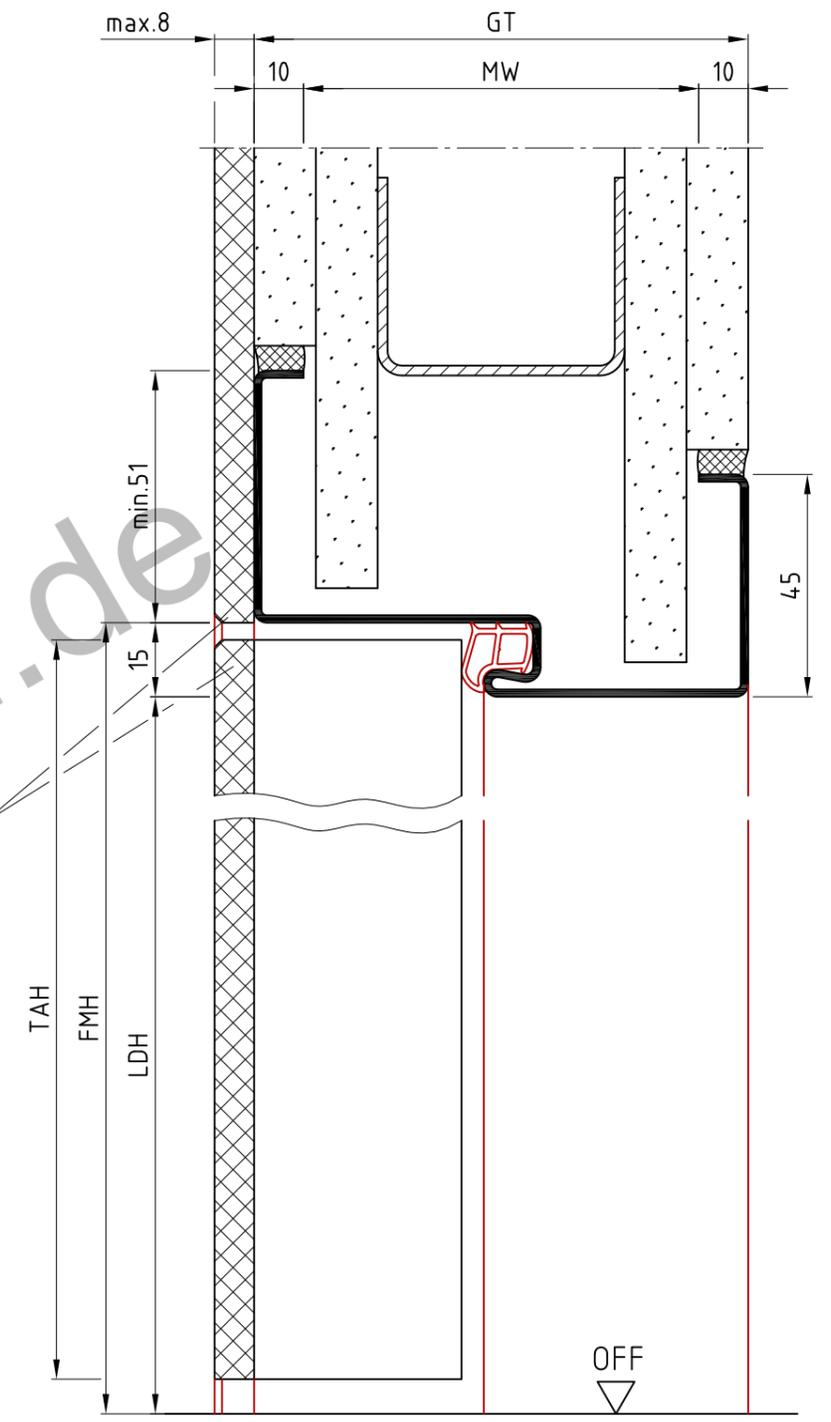
Zarge und Türblatt bauseits um max. 8mm aufdoppeln und die Aufdoppelung an den Außenkanten mit 45°-Fasen versehen.
