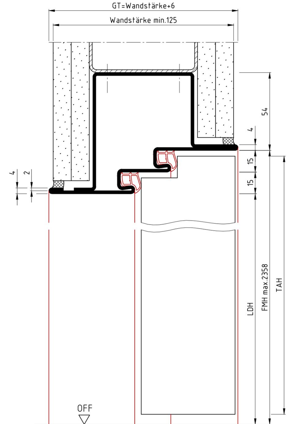
Die Massiv- und Ständerwerkswände bzw. deren Profile müssen so ausgebildet sein, dass sie die statischen und dynamischen Kräfte, welche sich aus der Belastung des verwendeten Türelements ergeben, zuverlässig und nachhaltig aufnehmen können.
