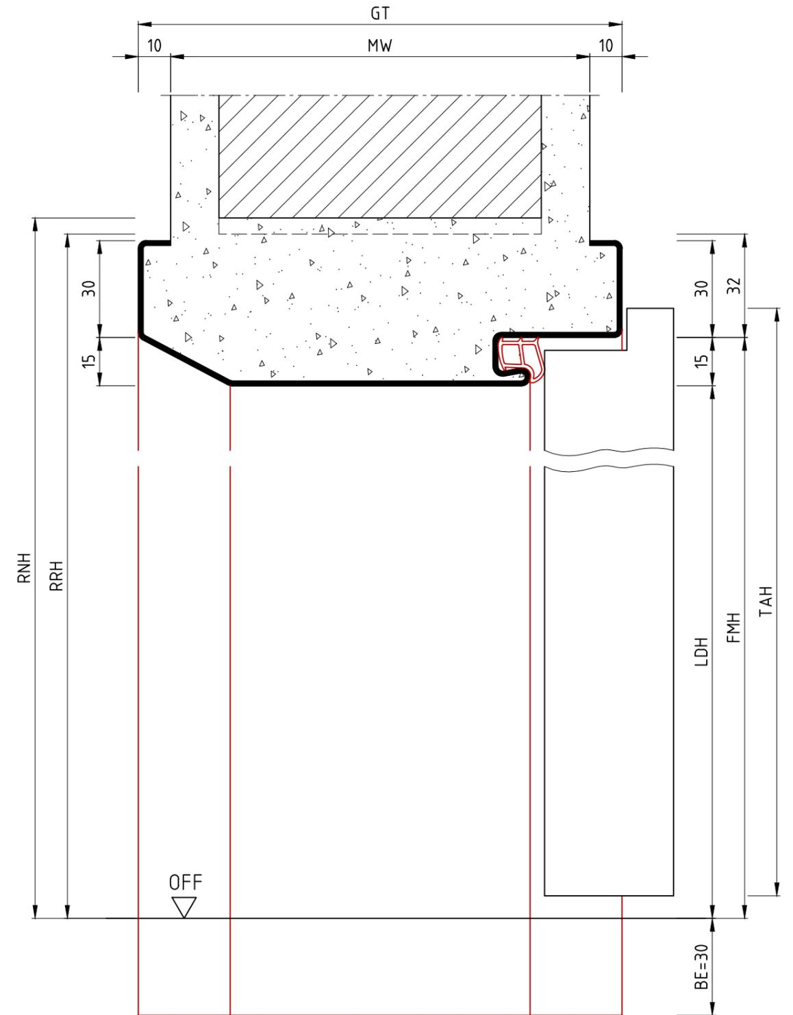
Die Massiv- und Ständerwerkswände bzw. deren Profile müssen so ausgebildet sein, dass sie die statischen und dynamischen Kräfte, welche sich aus der Belastung des verwendeten Türelements ergeben, zuverlässig und nachhaltig aufnehmen können.
