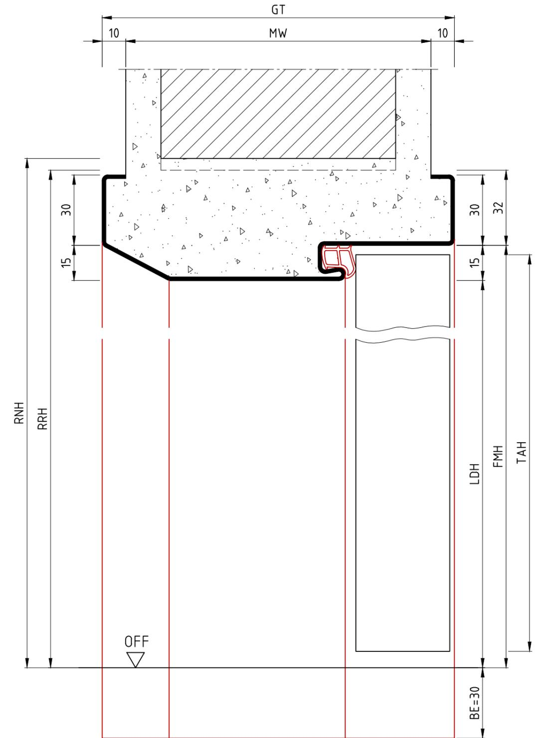
Die Massiv- und Ständerwerkswände bzw. deren Profile müssen so ausgebildet sein, dass sie die statischen und dynamischen Kräfte, welche sich aus der Belastung des verwendeten Türelements ergeben, zuverlässig und nachhaltig aufnehmen können.
