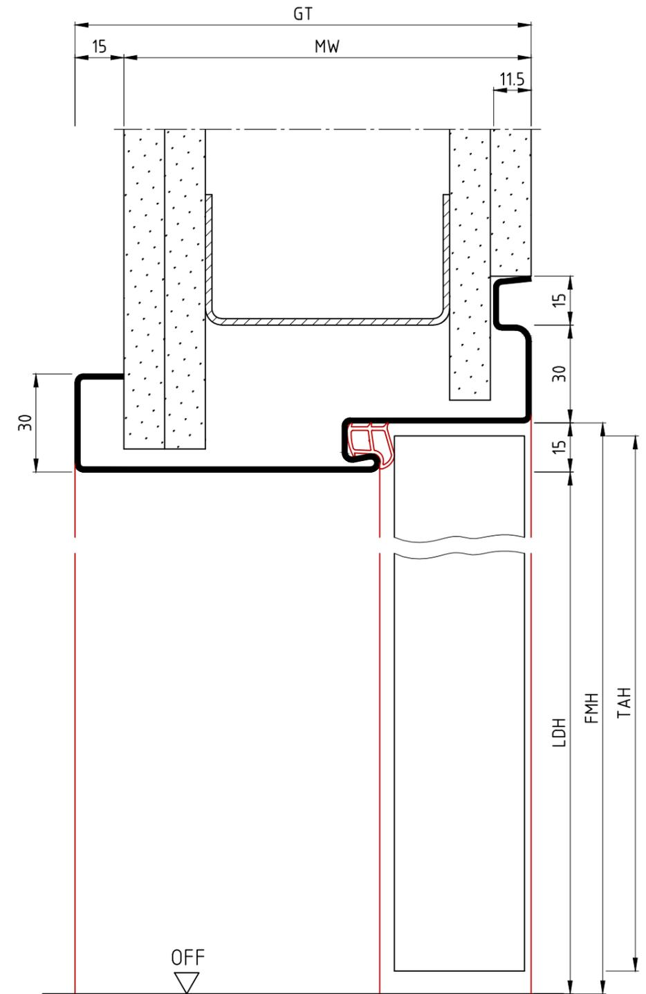
Die Massiv- und Ständerwerkswände bzw. deren Profile müssen so ausgebildet sein, dass sie die statischen und dynamischen Kräfte, welche sich aus der Belastung des verwendeten Türelements ergeben, zuverlässig und nachhaltig aufnehmen können.
