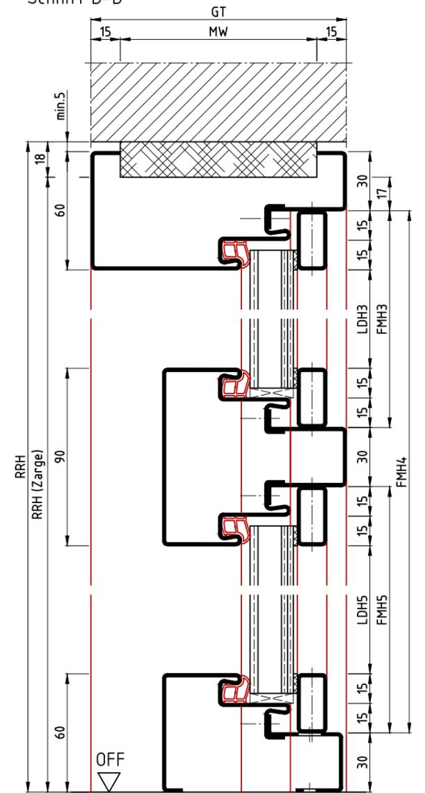
Die Massiv- und Ständerwerkswände bzw. deren Profile müssen so ausgebildet sein, dass sie die statischen und dynamischen Kräfte, welche sich aus der Belastung des verwendeten Türelements ergeben, zuverlässig und nachhaltig aufnehmen können.
