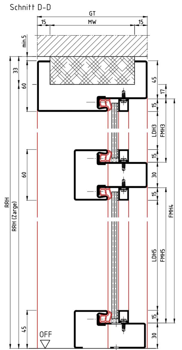
Die Massiv- und Ständerwerkswände bzw. deren Profile müssen so ausgebildet sein, dass sie die statischen und dynamischen Kräfte, welche sich aus der Belastung des verwendeten Türelements ergeben, zuverlässig und nachhaltig aufnehmen können.
