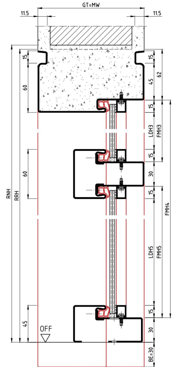
Die Massiv- und Ständerwerkswände bzw. deren Profile müssen so ausgebildet sein, dass sie die statischen und dynamischen Kräfte, welche sich aus der Belastung des verwendeten Türelements ergeben, zuverlässig und nachhaltig aufnehmen können.
