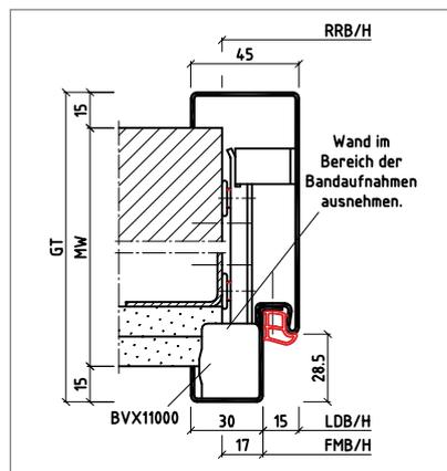
Das Rohbau richtmaß ist das Idealmaß zum Einbau der Duo 15Z.
