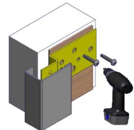
5. Vorder- (1) und Hinterschale (2) zusammenfügen. Beim Aufschieben der Hinterschale (2) darauf achten, dass diese zwischen den verkröpften Flachstahlankern (3) und der Vorderschale (1) verläuft.
