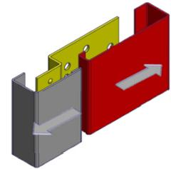
2. Vorderschale (1) in die Wandöffnung einschieben, in der Höhe dem Meterriss entsprechend ausrichten (Erläuterung Meterriss siehe Seite 3).
