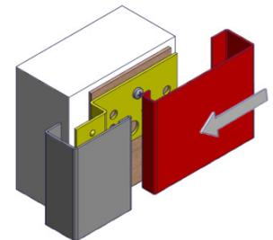
Der Putzwinkel (PH) der Hinterschale (2) muss am Mauerwerk oder an der Ständerwerkswand anliegen.
