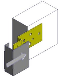
3. Die verkröpften Flachstahlanker (3) der Vorderschale (1) mit der druckfesten Unterfütterung (4) an der Wand (6) fixieren und mit einer Wasserwaage lot- und waagrecht ausrichten.
