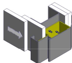
4. Elastik-Hohlkammerdichtung (6) erst nach dem Trocknen der Zargenlackierung einsetzen. Bei der Montage des Bandes die Hinweise auf der Dichtungsverpackung beachten.
