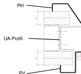
2. Die Zarge so ausspreizen, dass die Falzmaßbreite (FMB) in der gesamten Höhe eingehalten wird. Gegenüberliegendes vertikales UA-Profil (3) setzen. Schrägleibungszarge (1) mit einer Wasserwaage lot- und waagrecht ausrichten und anschließend ebenfalls über die Bügelanker (4) mit dem UA-Profil (3) kraftschlüssig verschrauben.
