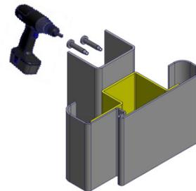
2. Die Rundspiegelzarge (1) so ausspreizen, dass die Falzmaßbreite (FMB) in der gesamten Höhe eingehalten wird. Gegenüberliegendes vertikales UA-Profil (3) setzen. Rundspiegelzarge (1) mit einer Wasserwaage lot- und waagrecht ausrichten und anschließend ebenfalls über die Bügelanker (4) kraftschlüssig mit dem UA-Profil (3) verschrauben.
