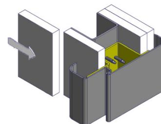
4. Elastik-Hohlkammerdichtung (6) erst nach dem Trocknen der Zargenlackierung einsetzen. Bei der Montage des Bandes die Hinweise auf der Dichtungsverpackung beachten.
